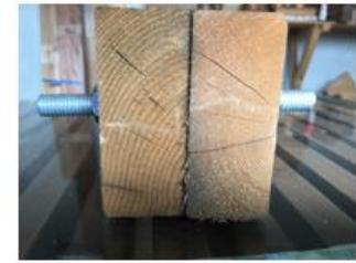
接続については、あらかじめ規定位置に指定のボルト径の穴を置けておき、ボルトにて連結して組み立てを行う。
